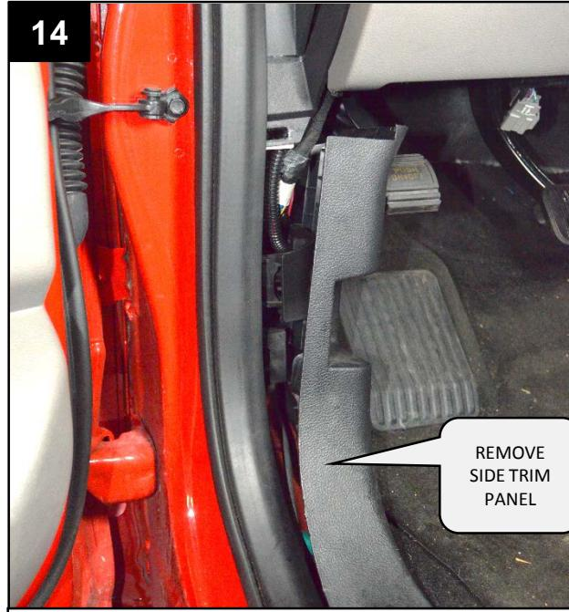
REMOVE SIDE TRIM PANEL LOCATED BY EMERGENCY-BRAKE.
